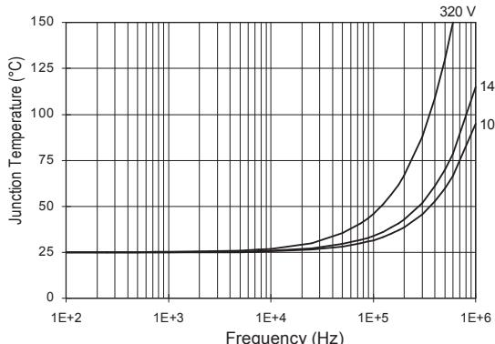
**Figure 30. IRS2112  $T_J$  vs. Frequency (IRFBC40)**
